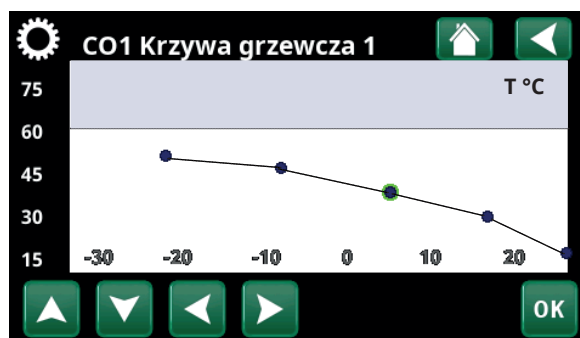
Menu: „Instalator/Ustawienia/Obieg grzewczy/Obieg grzewczy 1/ Krzywa grzewcza/Optymalne ustawienie”.
