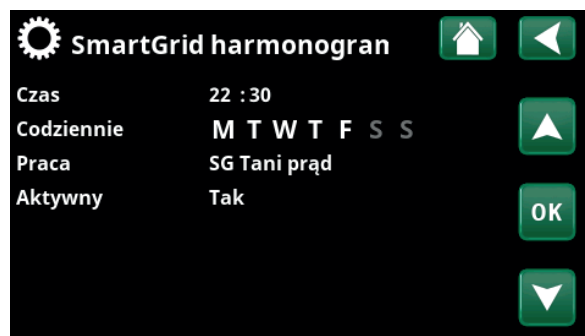
Menu: „Instalator\Ustawienia\SmartGrid harmonogramu”.
