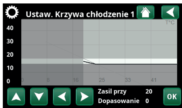
Menu „Instalator\Ustawienia\Chłodzenie\Krzywa chłodzenie/Ustaw. Krzywa chłodzenie”.
