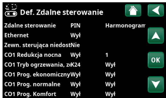
Część menu „Instalator\Definiowanie\Zdalne sterowanie”. Tutaj zdefiniowane są „Wejście” i „Harmonogramu”.
