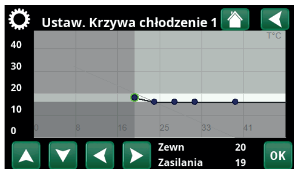
Menu „Instalator\Ustawienia\Chłodzenie\Krzywa chłodzenie/Optymalne ustawienie”.
