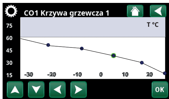
Menu „Instalator\Ustawienia\Obieg grzewczy\Obieg grzewczy 1/ Krzywa grzewcza/Optymalne ustawienie”.
