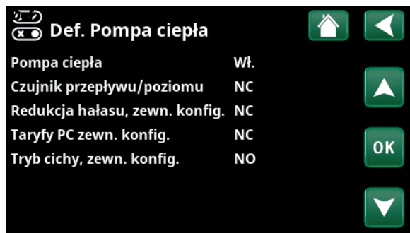
Menu: „Zaawansowany\Definiowanie\Pompa ciepła”. Tryb dla zewnętrznego sygnału sterującego (zwierny (NO) lub rozwierny (NC)).
