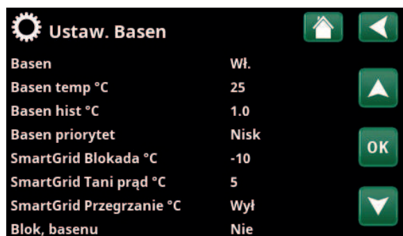
Menu: „Zaawansowany\Ustawienia\Basen”. Temperatura basenu po włączeniu funkcji SmartGrid Tani prąd wzrasta o 5 °C.
