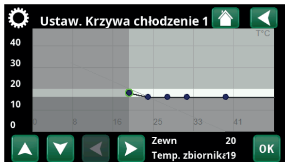
Menu „Zaawansowany\Ustawienia\Chłodzenie\Krzywa chłodzenie/Optymalne ustawienie”.
