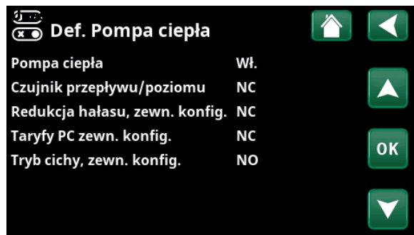
Menu: „Instalator\Definiowanie\Pompa ciepła”. Tryb dla zewnętrznego sygnału sterującego (zwierny (NO) lub rozwierny (NC)).
