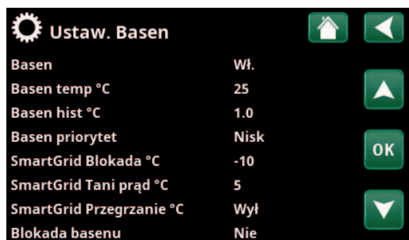
Menu: „Instalator\Ustawienia\Basen”. Temperatura basenu po włączeniu funkcji SmartGrid Tani prąd wzrasta o 5 °C.
